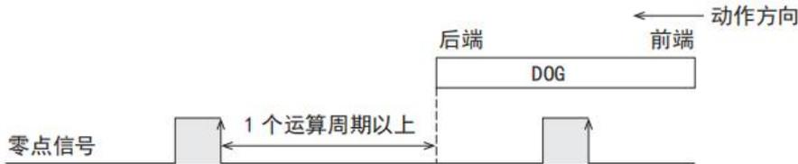
• 设计近点信号(DOG)时，请考虑有足够为 ON 的时间能充分减速到爬行速度。该指令在 DOG 的前端开始减速到爬行速度，在「DOG 的后端」或者「从 DOG 的后端开始检测出第一个零点信号」时停止，清除当前值寄存器。
